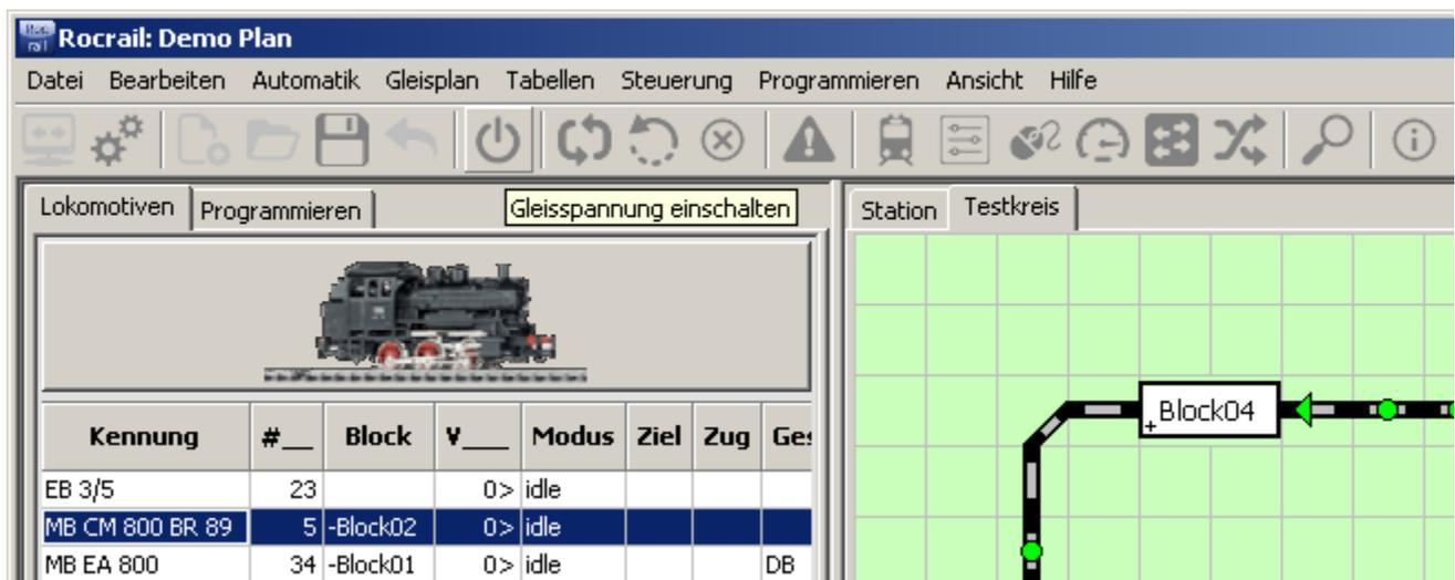
Den Knopf mit dem Einschaltssymbol (Gleisspannung einschalten) anklicken. Jetzt sollte die CS2 darauf reagieren und die Gleisspannung auch ein- und ausschalten (rot beleuchtete Stop-Taste).
