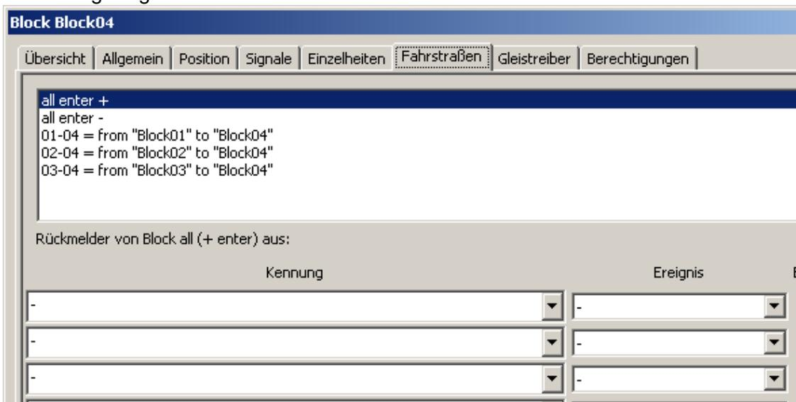
Bei allen spezifischen Einträgen, die vom Analyzer allenfalls hinzugefügt wurden (01-04 etc), ist unter Kennung und Ereignis nichts auszufüllen, wenn die Eintragungen unter "all enter ..." gültig sein können. Durch Kennungseinträge für die spezifischen Block-Zeilen unterhalb werden alle "all enter ..." Allgemeineinträge unterdrückt.
